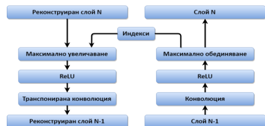
Фиг. 13. Деконволюционен слой (вляво) „закачен“ към стандартен конволюционен слой в CNN (вдясно).
