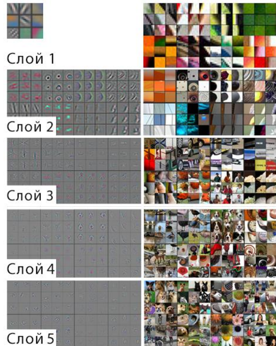
Фиг. 12. Визуализация на слой 1, 2, 3, 4 и 5 (модифицирано заимствана от [7]). Вляво (по слоеве) са визуализирани филтрите, а вдясно са показани части от тренировъчните изображения, най-силно активирани от съответния филтър.
