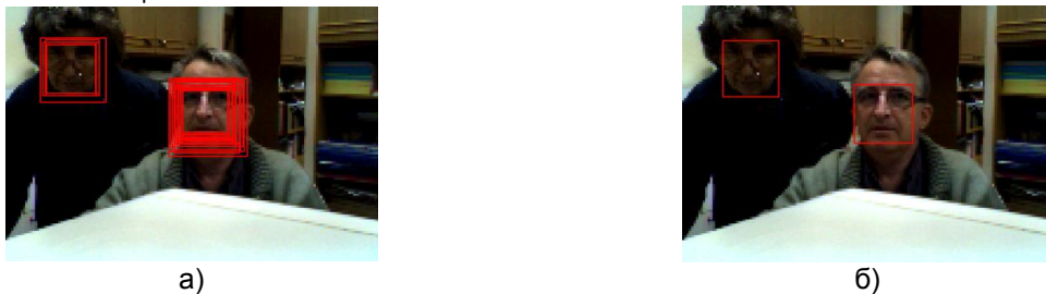
Фиг. 5 Откриване на лица: а) две лица в различен мащаб, множество намерени; б) краен резултат
